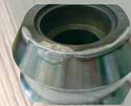
Soldadura con recarga de material
